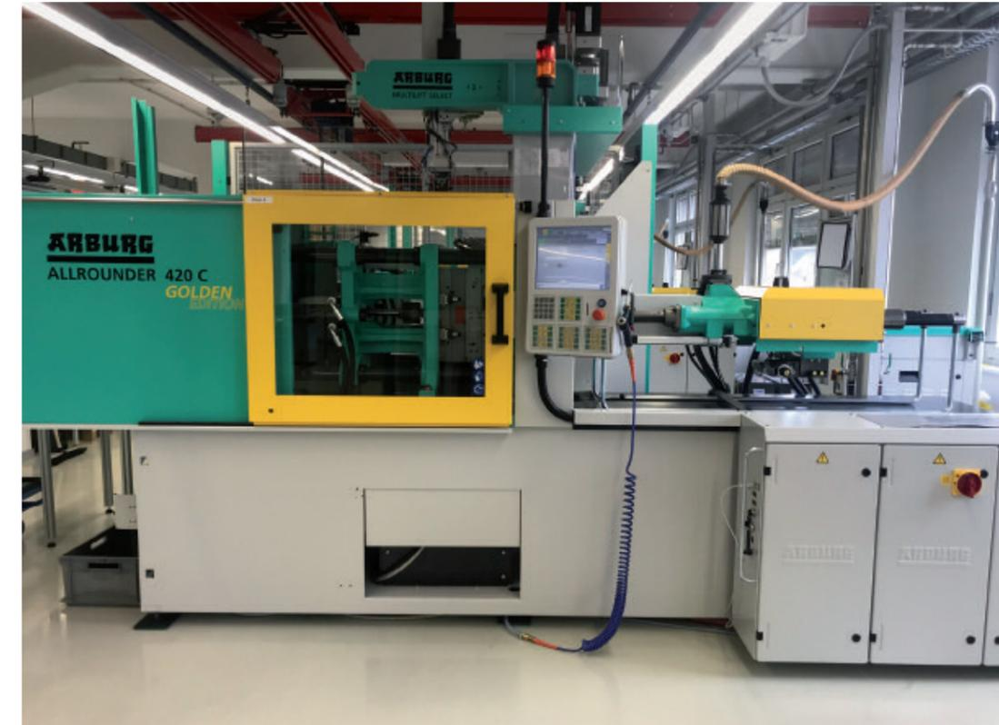
Moderne Technologie: Spritzgießmaschine für Kunststoffteile.
